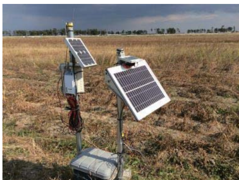
写真1：宮城県津波被災農地におけるICT土壌水分塩分観測システムの設置風景
